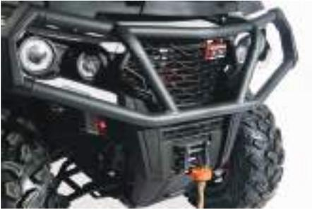
Toda nuestra gama cuenta con un winch de serie ,el cual viene equipado con cable sintético lo que garantiza su máxima seguridad. El mismo es controlado mediante un practico swith incluido en la piña izquierda. Por otro lado podrá instalar defensas homologadas tanto delanteras como traseras. (De serie en 1000cc)
